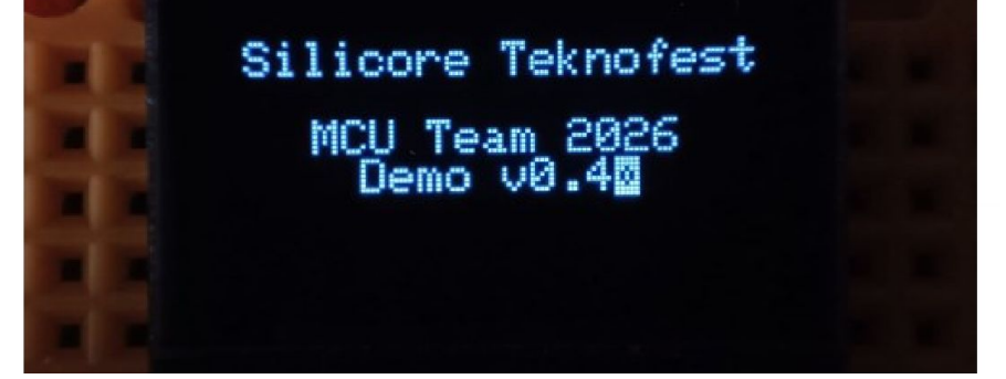
I2C ile sürülen OLED — demo v04 basamağı, kart üzerinde
